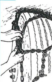
После этого руками расправьте цепь по поверхности колеса путем стягивания внешней боковой цепи, после чего зацепите замок боковой цепи.
