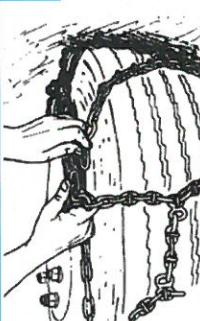
Zatim ručno stegnite lanac oko kotača povlačenjem lanaca s vanjske strane prema sebi. Zatim kukom zajedno pričvrstite vanjske lance.
