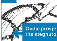
Stegnite lanac zatezačem umetanjem poluge za zatezanje u utor zatezača i zatim zakrenite polugu za 90 stupnjeva kako bi prsten lanca skliznuo u zaključani položaj (6).
