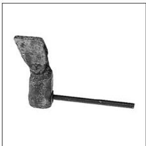
Fig. 3: Loddebolt med behov for smiing
