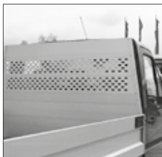
Gitterlem, lengde 2500 mm Profilen integreres i system BW25 Stykkogodslem
