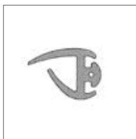
Profilnavn: Gummipakning Profilnr.: TD-KAP-25 For profil K10201
