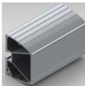
Aluminium underkjøringshinder, eloksert Godkjent i henhold til EU direktiv CE70/221/CEE inkl. tillegg 2006/96/CE Leveres med 2 stk. endelokk i aluminium og 2 stk. gjengende innfestningsdetaljer i rustfritt stål.
