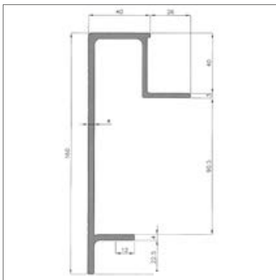
Profilnavn: Kantrammeprofil Profilnr.: 4T-810 Vekt: 2,95 kg/m Tilpasset: 25 mm lemsystem 90 mm tverrbjelke Hjørneprofil K13915 Undermontert hengsel 1513
