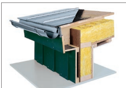
Ventilert takkonstruksjon 2 med ventilert bæreramme, uten full taksperreisolasjon og med strukturmatte
