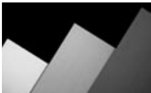
Fig. 1: RHEINZINK-overflater valseblank, "forpatinert PRO blågrå" og "forpatinert PRO skifergrå"
